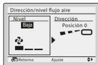
6 Con el ajuste de la velocidad del ventilador seleccionado, utilice para seleccionar la velocidad que desee.
