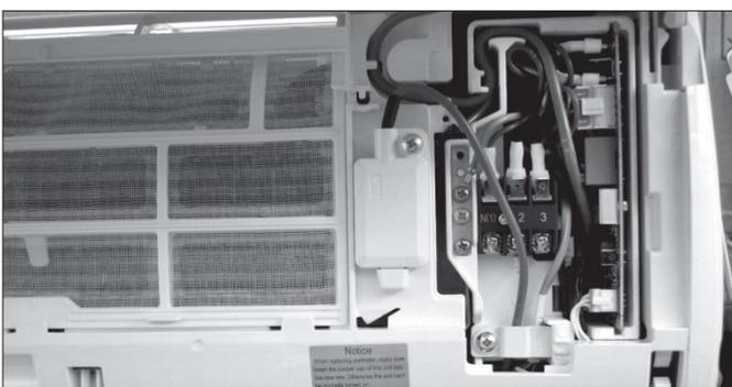
3. Retire el clip del cable, saque el cable de conexión WIFI de la caja electrónica y conéctelo al puerto de conexión del módulo WIFI.
