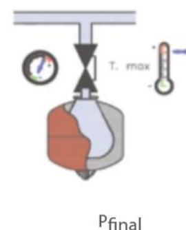
Una vez presurizado el vaso de expansión y tomadas las precauciones oportunas, procedemos a comunicar el vaso de expansión con la instalación o conducción. Una vez instalado el vaso de expansión, este funciona automáticamente.
