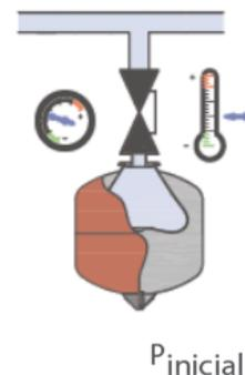
**Rellenado de agua de la instalación:** A la hora de ajustar la presión más elevada en el rango de funcionamiento del sistema de calefacción  $P_{fin}$ , este valor no debería ser mayor que la presión de ajuste de la válvula de seguridad  $P_{vs}$  menos una diferencia de la sobrepresión de cierre, tal y como se indica en la norma EN12828.
