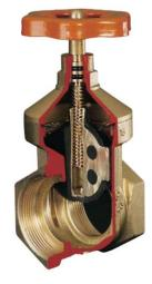
La válvula de compuerta es del tipo multivueltas, en la cual se cierra el paso con un obturador vertical de caras planas, que se desliza en ángulo recto sobre los asientos. Este tipo de válvula se recomienda para servicios donde se necesita una apertura o cierre sin estrangulación (paso total), para uso poco frecuente y donde se necesita una resistencia mínima a la circulación.
