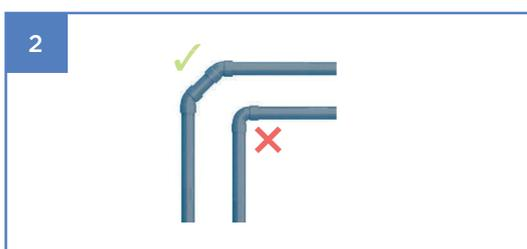
• Las curvas deben ser fluidas, con un amplio radio de curvatura, sin codos cerrados.
