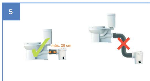
• El aparato debe estar colocado detrás del inodoro a 20 cm como máximo. No se puede instalar a un nivel inferior.
