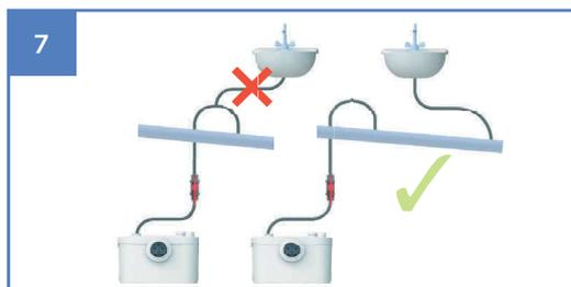
• No se puede conectar ningún aparato sanitario al tubo de evacuación de pequeño diámetro del triturador.
