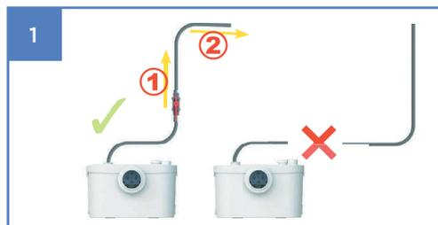
• La elevación vertical debe realizarse al principio del circuito de evacuación (1) y se debe instalar una llave de corte para el mantenimiento. Desde el punto más alto del desagüe (2), se requiere una pendiente al menos del 1%.
