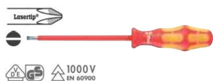
**Aplicación:** para tornillos planos · **Varilla:** aislada · **Punta:** DIN 5264-A, ISO2380, punta cónica, Lasertip® · **Empuñadura:** Kraftform® con protección antideslizamiento, multi componente
