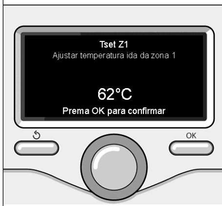
Modificação temperatura água quente aquecimento
