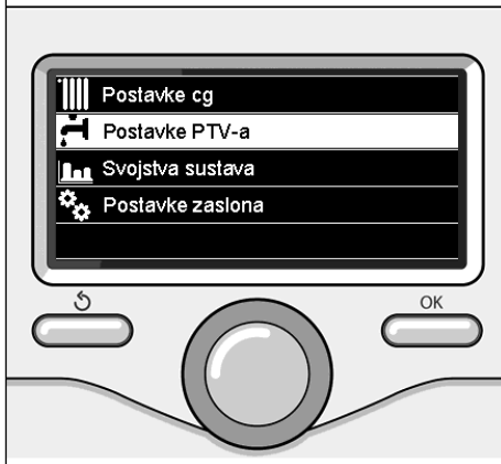
Odabir određivanja postavki tople vode
